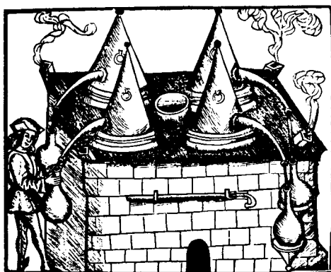
Distillatori con cappello a cono per il raffreddamento ad aria. (Da: «Das nÿv Buch der rechten Kunst zu distillieren», Strasburgo, 1509).
